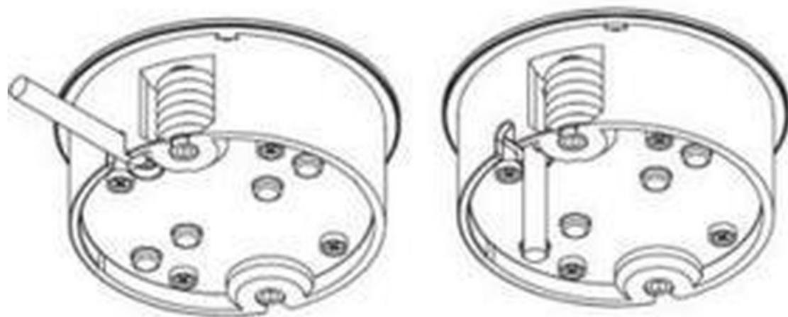
Die Zuleitung ist zugentlastet und kann frei nach unten hängend oder innerhalb der Einbautiefe seitlich in der Tischplatte verlegt werden
